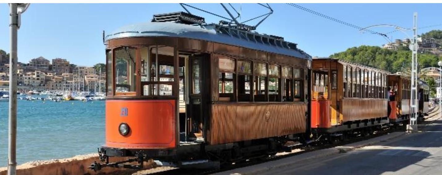
**EL FERROCARRIL DE SÓLLER** se caracteriza, entre otras cosas, por ser un ferrocarril de vía estrecha, con un ancho de vía de 914 mm (yarda inglesa) poco común en la actualidad y por presentar un material móvil antiguo muy variado, de carácter detallista y mantenimiento artesanal.
