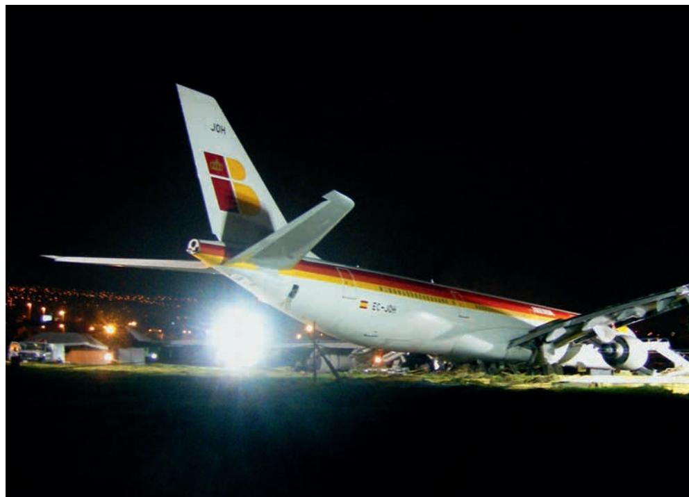
También contemplaba el cambio de la estructura secundaria dañada, incluidos el carenado del vientre y la estructura de sujeción.
